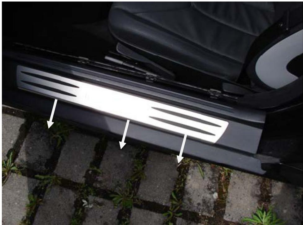
Image 2 : Tirer le seuil de porte vers l'extérieur pour le démonter
