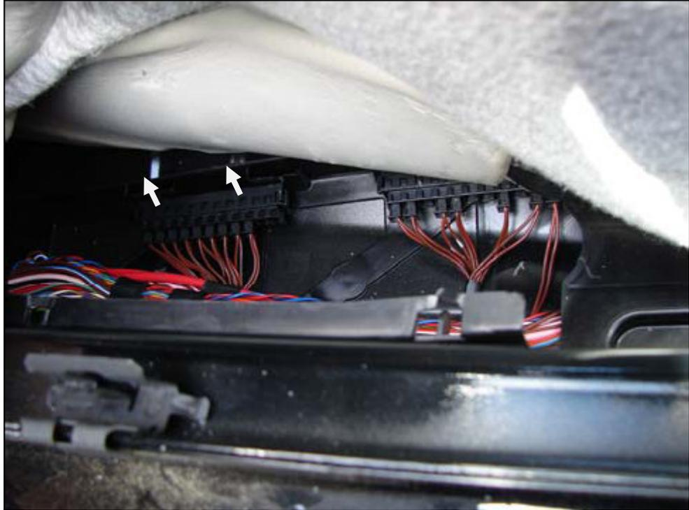
Image 5 : Le boîtier du faisceau ouvert, le distributeur-CAN
